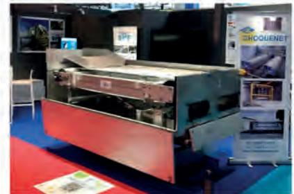
Les applications de l'équipement concernent l'épaississement pour un épandage liquide avec une structure ajustable en fonction des matériels d'épandage utilisés, la déshydratation pour élimination sous forme solide par épandage, compostage ou stockage contrôlé ou l'épaississement en amont d'un filtre-pressé
