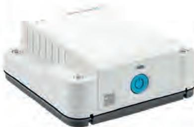
La nouvelle génération d'instruments de niveau Micropilot FWR30 couvre des gammes de mesure jusqu'à 15 mètres pour des températures ambiantes comprises entre -20 °C et 60 °C, et peut être utilisée pour tous les produits liquides. Grâce à son capteur IoT sans fil 80 GHz, le Micropilot FWR30 fonctionne là où d'autres principes de mesure ne peuvent être appliqués en raison de la corrosion, de l'abrasion, de la viscosité ou de la toxicité. Il vise par conséquent de nombreuses industries.
