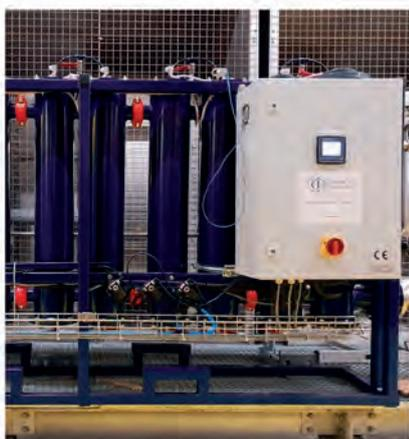
**blubalance** est une solution de traitement des eaux de refroidissement sans produit chimique, qui permet de lutter contre le tartre, la corrosion et la biocontamination. La solution permet de diminuer la micropollution liée aux produits chimiques et de réaliser en moyenne 30% d'économies d'eau.
