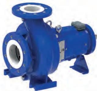
Cette gamme fonctionne pour des tailles de DN25 à DN250, des débits jusqu'à 1 100 m<sup>3</sup>/h et une hauteur d'élévation maximale de 160 m. Ses caractéristiques permettent de répondre à de fortes pressions à l'aspiration, pour des applications industrielles comme la chimie, la pétrochimie, la sidérurgie, mais aussi le chauffage urbain ou la production d'eau chaude et d'eau froide dans les bâtiments.
